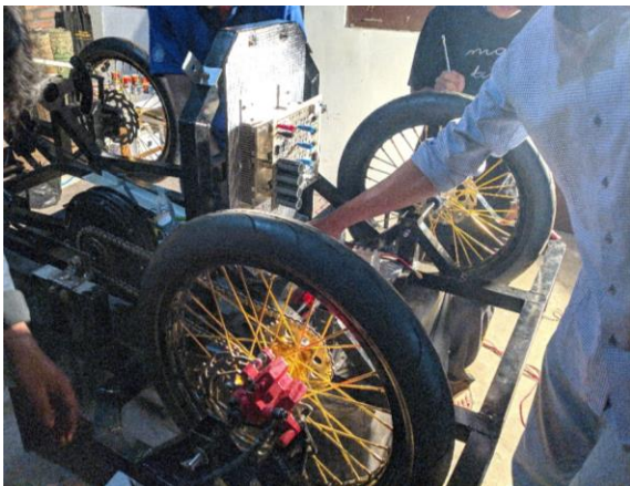
Gambar .7 pemasangan sistem penggerak pada sasis
