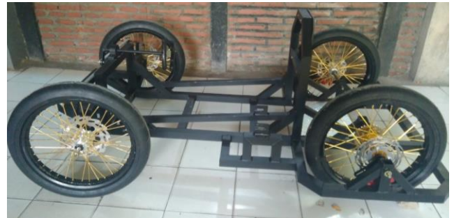
Gambar.4 Manufaktur sasis dengan roda
