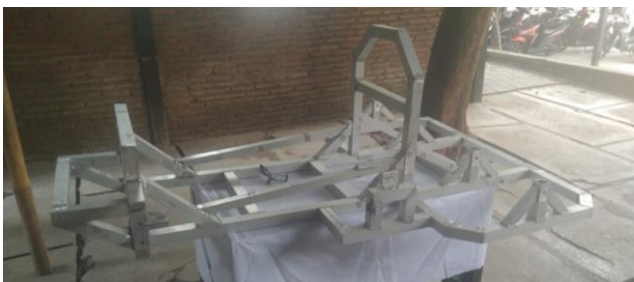
Gambar 3. Hasil manufaktur sasis berdasarkan desain
