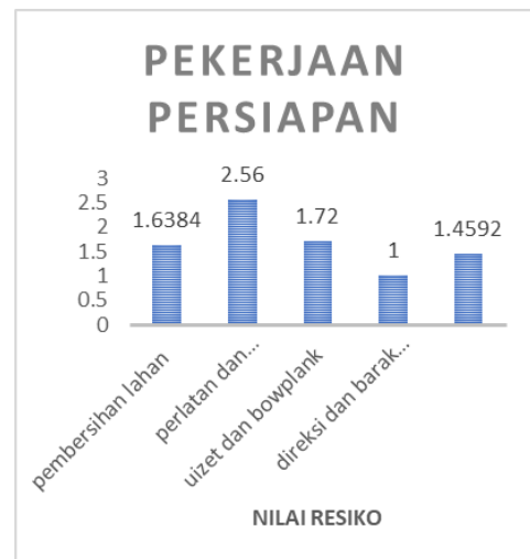
Gambar 1. Risiko pada pekerjaan persiapan
