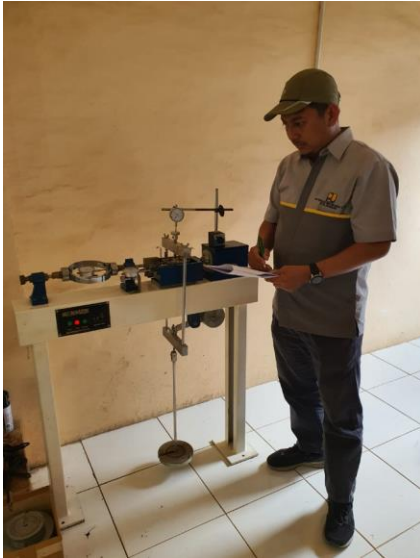
Gambar 6. Pengujian Kuat geser dengan Direct shear
