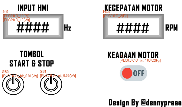
Gambar 6: Desain antarmuka layar HMI
