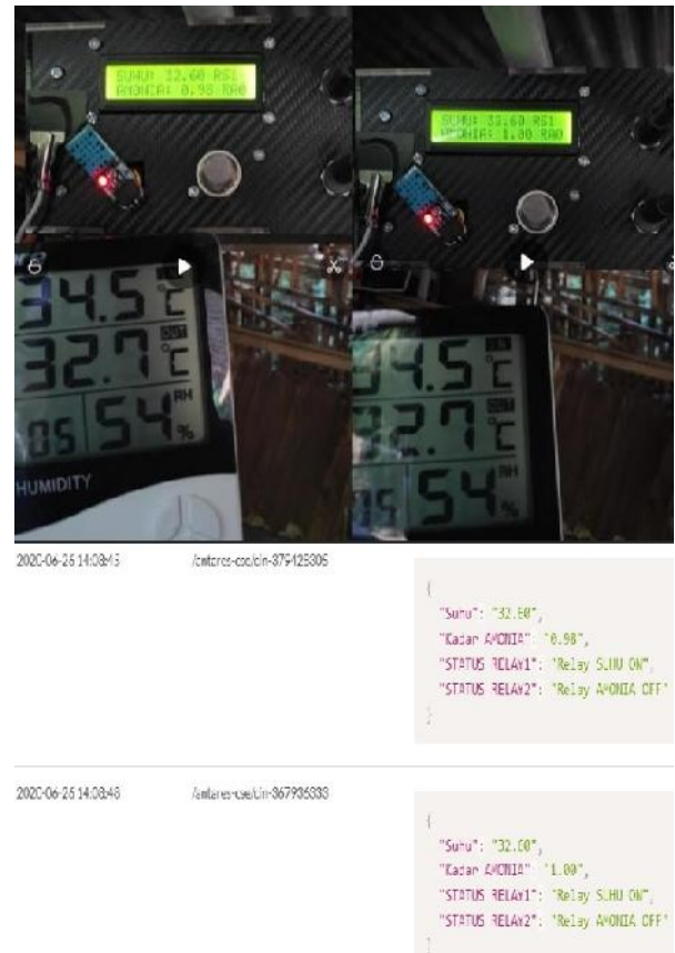
Gambar 6. Tampilan hasil pembacaan sensor di LCD dan platform Antares
