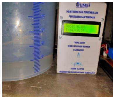
Gambar 6. Perbandingan antara alat monitoring pengendalian air dengan gelas ukur
