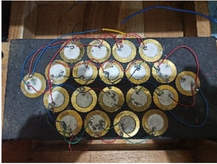
Gambar 15: Sensor Piezoelektrik Disusun 5 Paralel 4 Seri
