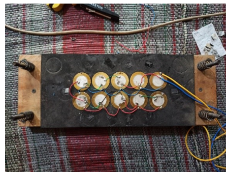
Gambar 7: Sensor piezoelektrik disusun 10 paralel
