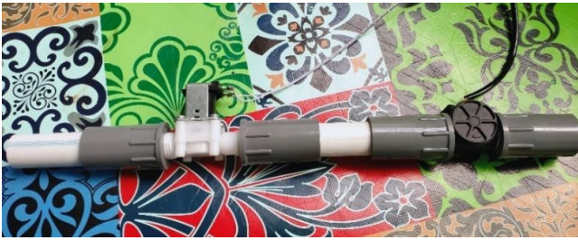
Gambar 5: Rangkaian pipa PVC dengan solenoid Valve dan Flow meter
