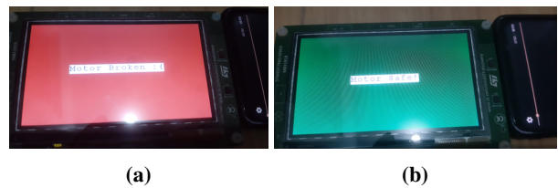
Gambar 11: Hasil pengujian menunjukkan (a) berhasil mendeteksi rusak pada pengujian pertama (b) gagal mendeteksi rusak pada pengujian ke 6, 8 dan 12
