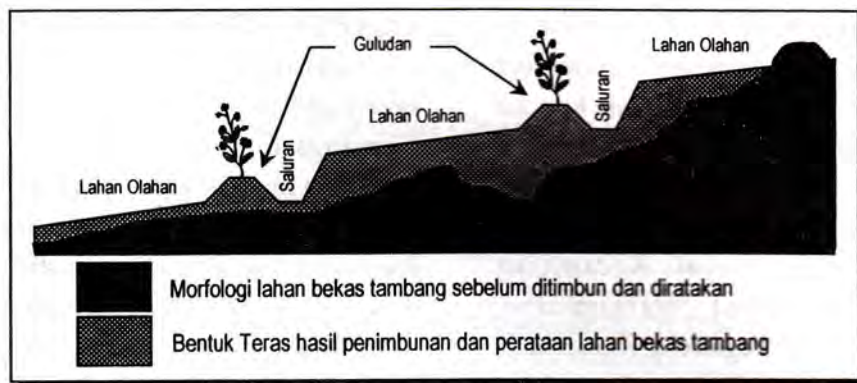
Gambar 20. Konstruksi Konservasi Mekanik Teras Guludan yang Dikombinasikan dengan Konservasi Vegetatif pada Lahan Bekas Penambangan Zeolit yang Relatif Datar.
