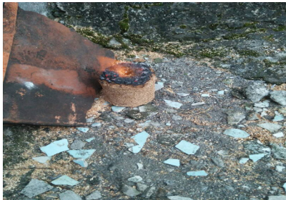
Gambar 1. Biobriket dari limbah baglog jamur
