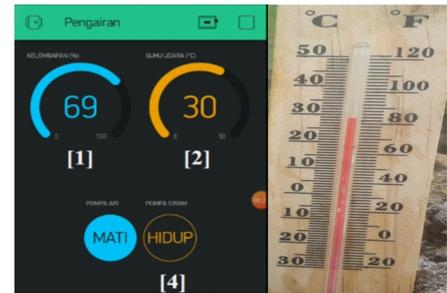
Gambar 26. Pengujian Lapangan Sensor Pengukur Suhu
