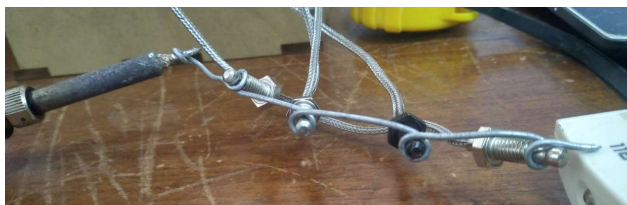
Gambar 16. Metode Pengukuran Laju Perpindahan Kalor dengan Kawat Besi
