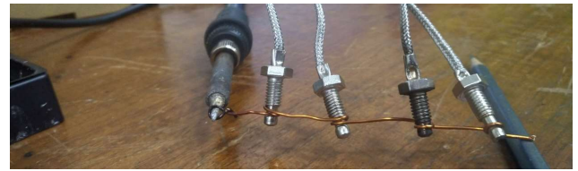
Gambar 17. Metode Pengukuran Laju Perpindahan Kalor dengan Kawat Tembaga
