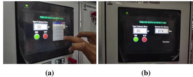
**Gambar 8:** Tampilan layar sentuh HMI pada saat pengujian (a) saat mereset layar (b) saat pengukuran kecepatan motor
