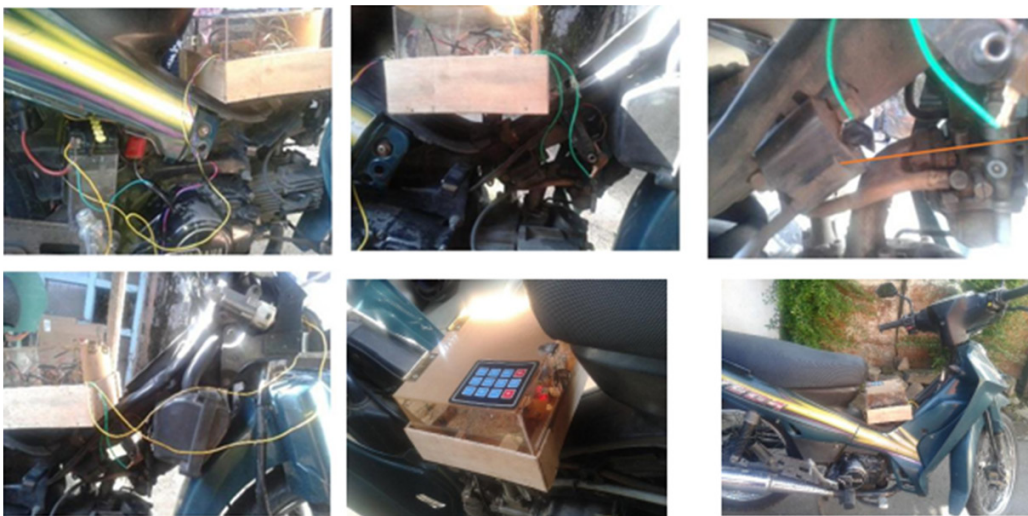
Gambar 17. Contoh pemasangan alat pada sepeda motor "Vega"; Gambar kiri atas adalah pemasangan kabel sumber tegangan pada aki sepeda motor; Gambar tengah dan kanan atas adalah pemasangan kabel relay pada kunci kontak; Gambar kiri dan tengah bawah adalah pemasangan kabel relay alarm ; Gambar tengah dan kanan bawah memperlihatkan posisi alat pada sepeda motor.
