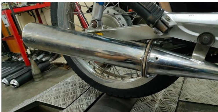
Gambar 2. Knalpot Modifikasi yang Dilengkapi dengan MCC CuCr
