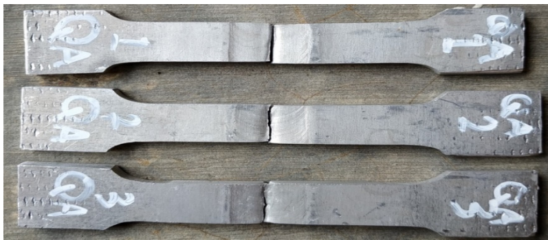
Gambar 5. Bentuk spesimen setelah di uji tarik yang di Annealing
