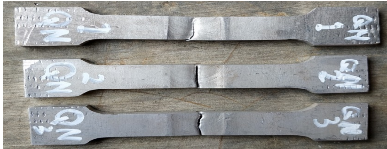
Gambar 4. Bentuk spesimen setelah di uji tarik yang di Normalizing
