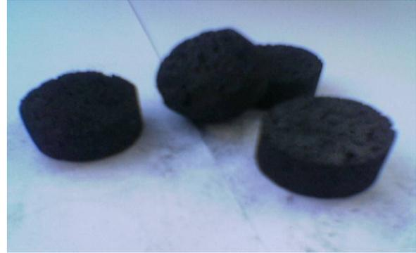
**Gambar 4. Green coke untuk uji pembakaran**
