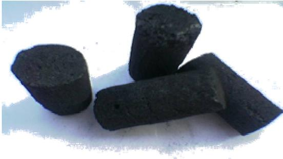
**Gambar 3. green coke untuk uji mekanis**
