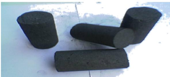
**Gambar 1.** kokas impor untuk uji mekanis
