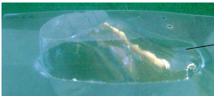
Gambar 8. Contoh penyusutan pada plastik PVC
