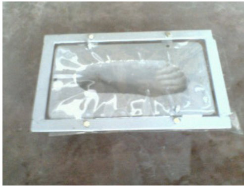
Gambar 3 Pemasangan plastik pada penjepit
