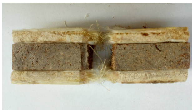
Gambar 9. Permukaan patah komposit sandwich hibrid pada V_f = 40\%
