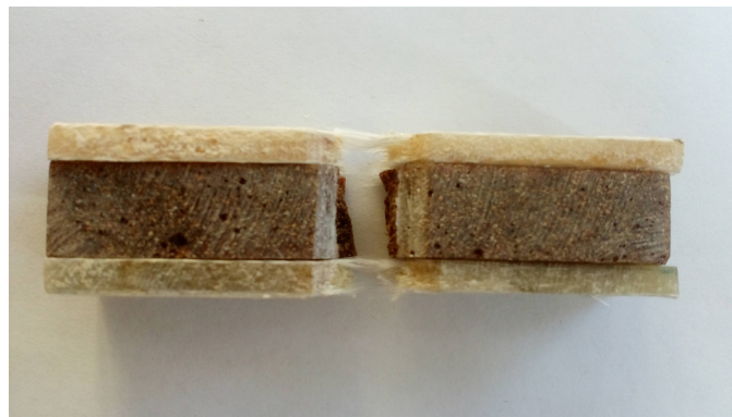
Gambar 8 Permukaan patah komposit sandwich hibrid pada V_f = 30\%
