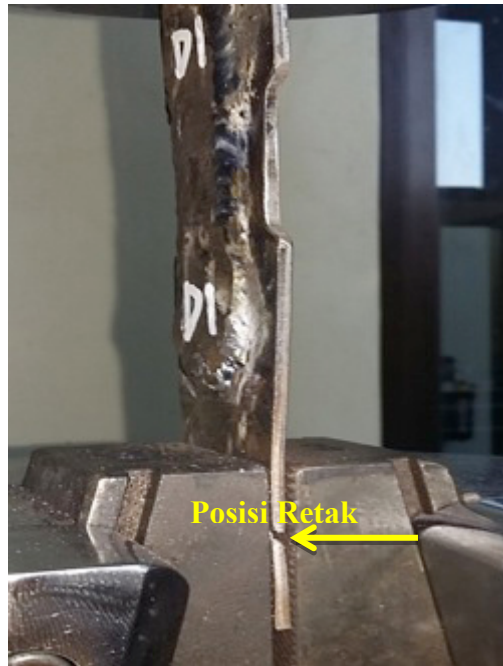
Gambar 10 Posisi penjalaran retak pada Spesimen D1
