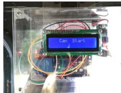
Gambar 13. Tampilan Safety Device Ketika Level Oli Mencukupi
