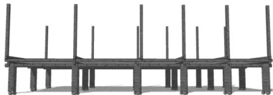
Gambar 11. 3D sambungan kolom dan balok tidak menerus
