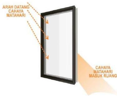
**Gambar 14.** Ilustrasi pencahayaan alami masuk ke dalam bangunan
