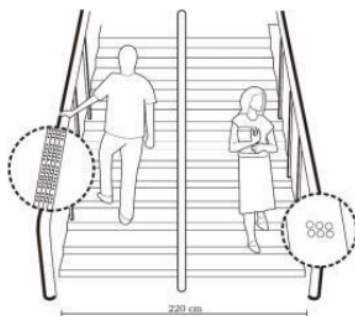
Gambar 7. Standar railing tangga dengan huruf braille sebagai jalur pemandu (sumber: Permen PUPR No. 14 tahun 2017)
