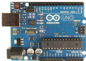
Gambar 1 Bentuk fisik Arduino Uno R3
