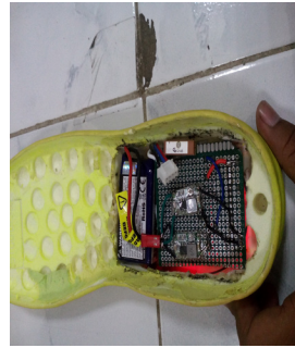
Gambar 10. Alat pelacak dalam sol sepatu
