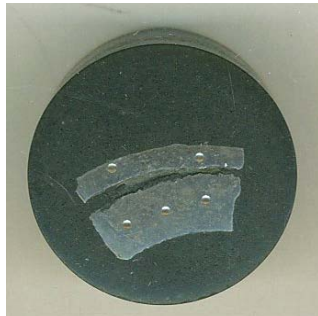
Gambar 4. Lokasi Titik Spesimen Uji Kekerasan
