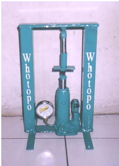
Gambar 5. Alat Pengepres Biobriket
