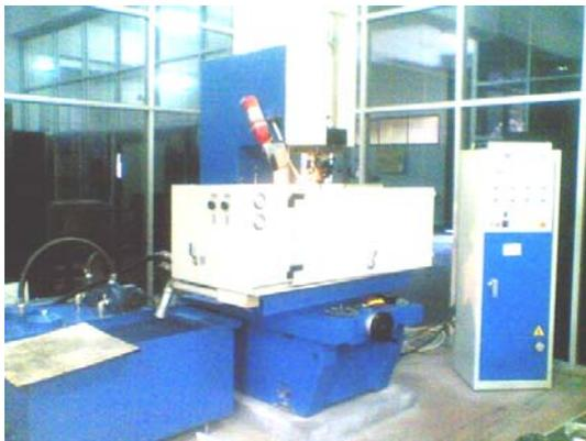
**Gambar 1. Mesin EDM**
