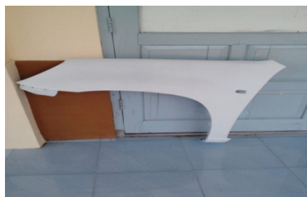
Gambar 6. Fender yang sudah dilapisi cat warna putih
