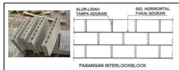
**Gambar 2.** Bentuk dan pemasangan interlockblock
